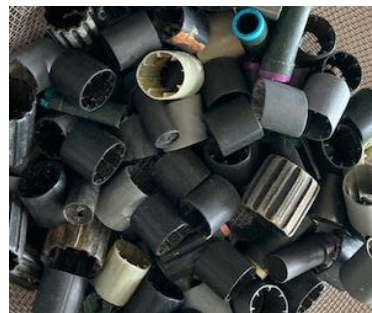
下水処理で使用されている担体
