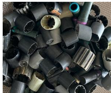
下水処理で使用されている担体
