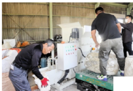
フロートを燃料化する機械。上部からフロートを投入すると、下部からブロック状で排出される=明石市二見町東二見
