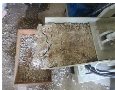
図2 破碎刃と破碎されたフロートの様子 図3 圧縮減容されたフロート
