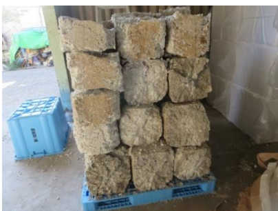
図4 圧縮減容されたフロートのブロックを積み重ねたところ
