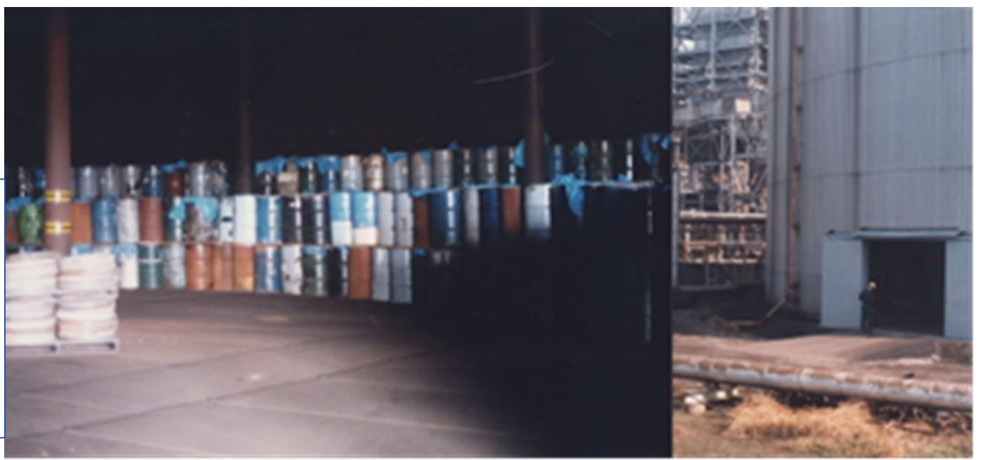
図48 大きなタンク側面を開口し、内側にドラム缶を保管 北九州の処理場 サニックス
