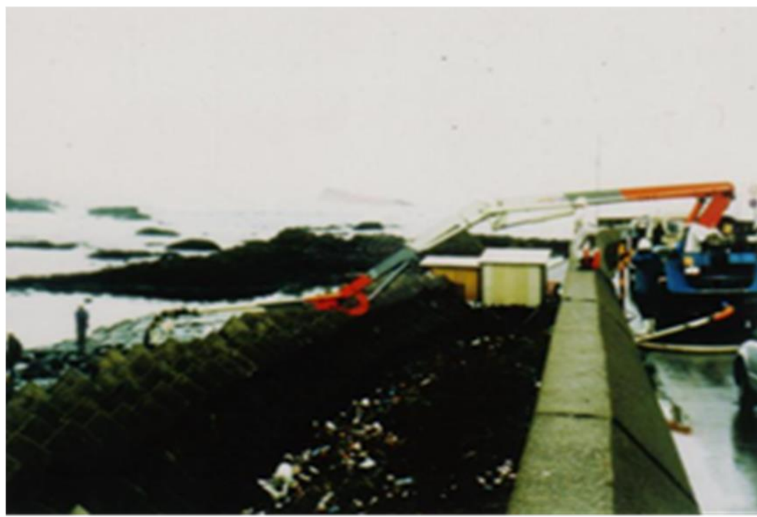
図25、26 1月20日三国でポンプ車による漂着油の回収
