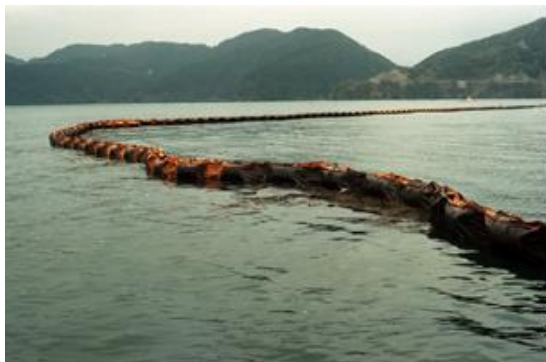
図19 漁港の湾 南北に展張された状態。風向きにより左右に振れて油が集まるなど様々の工夫がされていた。
