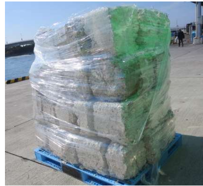
発泡フロートを圧縮処理。容積を1/30に圧縮し、燃料ペレットの原料にリサイクル
