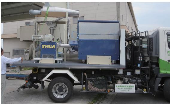
図2.2 ペレット造粒機の搬入の様子
