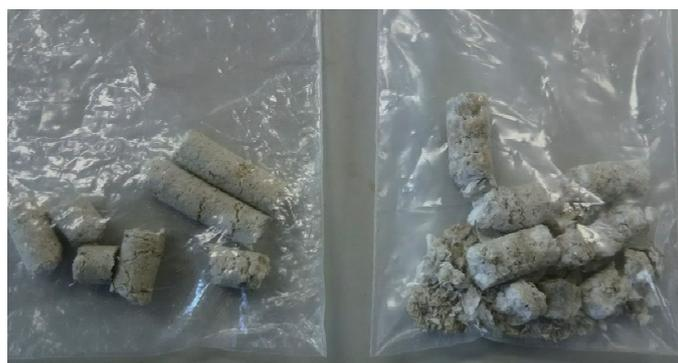
図 2.5 左側が1号機、右側が2号機で造粒されたペレット
