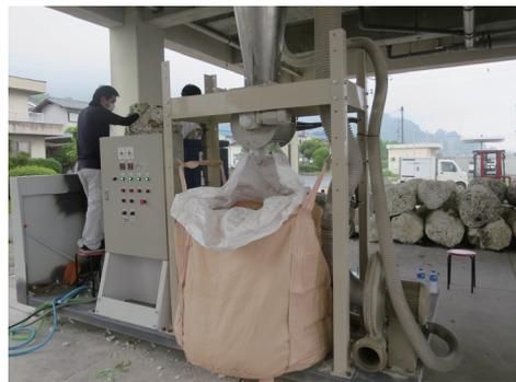
図2.3 ペレット造粒機の裏面
