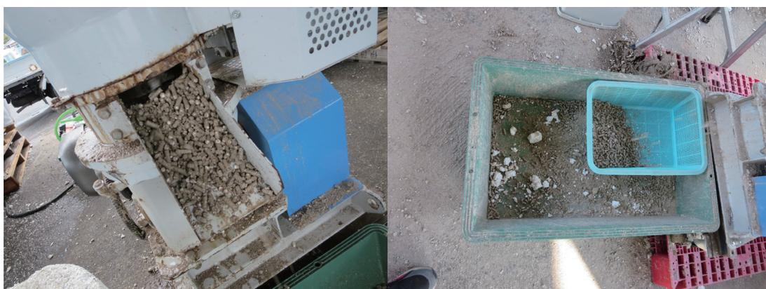
図2.32 排出口に溜まるペレット(左)と水分を取り除くためザルに入れたペレット(右)
