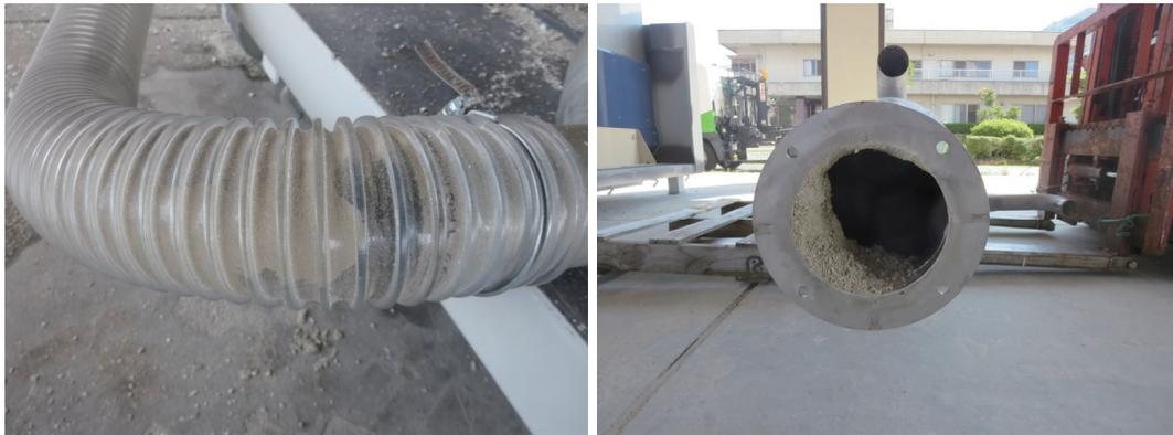
図2.16 付着した発泡スチロールの紛体(左:ホース、右:円筒部)
