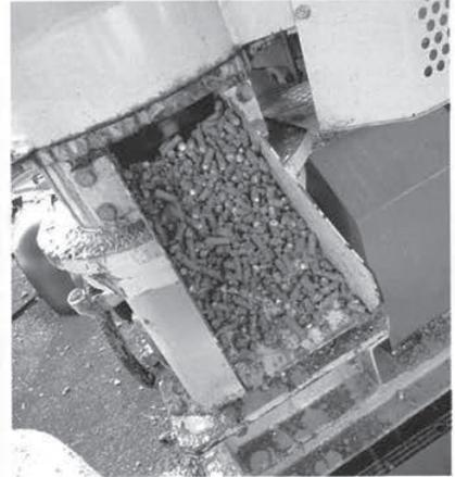
写真6 ペレット造粒機と作業の様子
