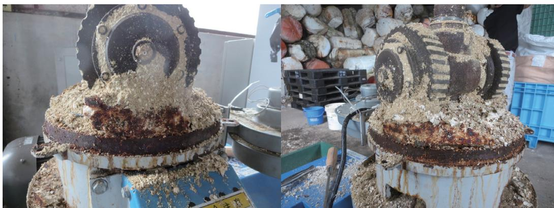
図2.22 装置の温度が上昇したことによって焦げた発泡スチロール
