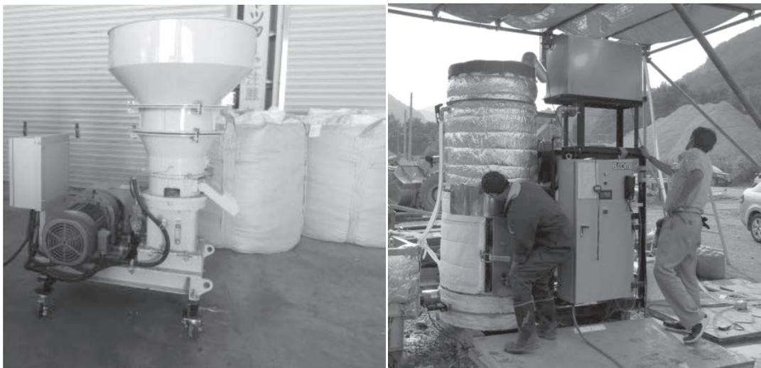
図 1.1 事業で開発した発泡スチロール製ペレット造粒機(左)と温水ボイラー(右)
