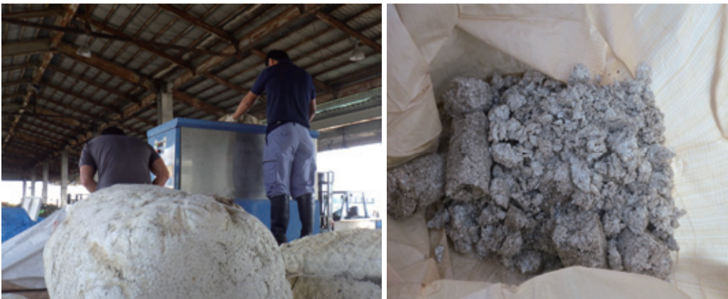
図 2.6 圧縮減容機の概要図(上)作業風景(下左)、減容の一例(下右)
